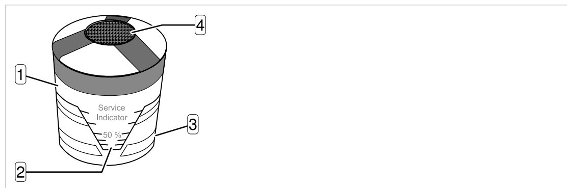
Fig. 43 Comprobar el indicador de mantenimiento del tubo de aspiración del filtro de aire del motor
